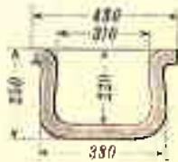
Äußere Abmessungen: 1360 × 430 × 250 mm, Gew. etwa 62 kg, 1 St. M. 12.00
