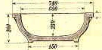
Äußere Abmessungen: 740 × 530 × 260 mm
