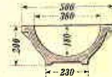
Äußere Abmessungen: 500 × 500 × 200 mm
